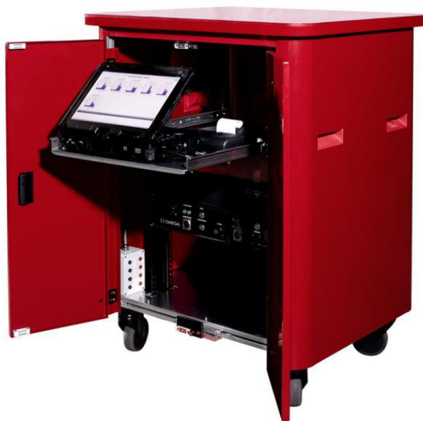
Figura 5 - Omega: all'interno di questo cassone è contenuto tutto il materiale hardware che gestisce il Sistema di rilevamento delle False Partenze
