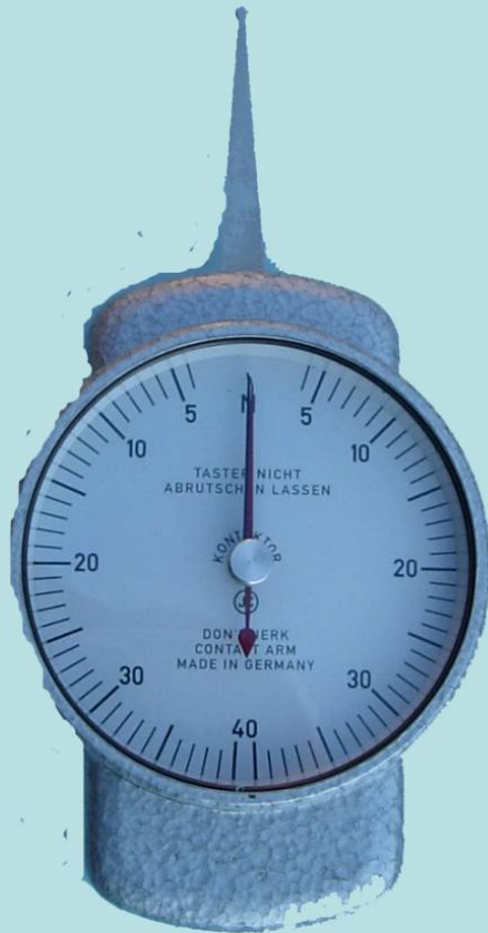
Dinamometro Kontaktor JC - Juwel - Certificato a spinta
