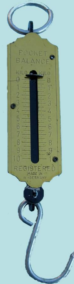
Dinamometro a bilancia a trazione
