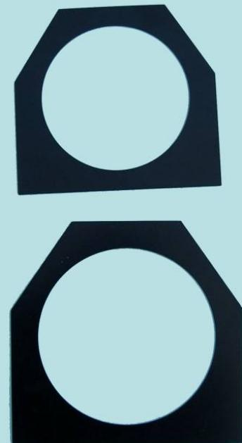
**N.B.** Per i diametri extra dime (in assenza di relative dime), procedere con la rilevazione, con un flessometro, di almeno tre circonferenze della sfera e fare la media delle tre misure e dividere per 3,1416. Il risultato determina il diametro
