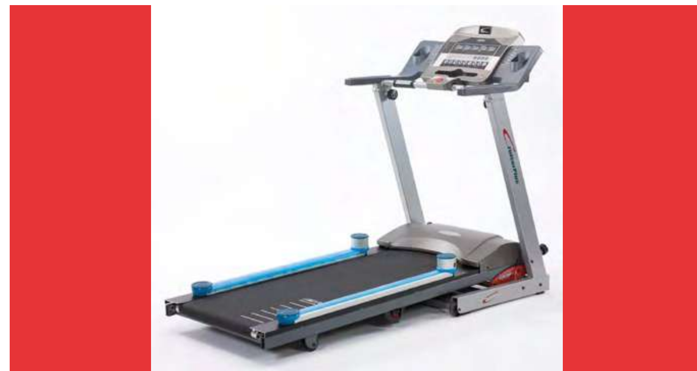
Figura 25: OptoGait installato su treadmill per misurare i tempi di contatto di ciascun piede nella camminata. Immagine tratta dal sito ufficiale Microgate
