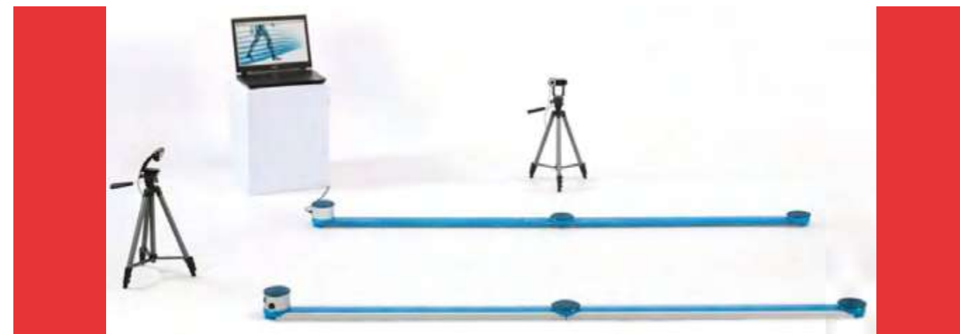
Figura 24: OptoGait serie da 2 moduli, PC connesso alla barra ricevente e 2 videocamere ad alta frequenza. Immagine tratta dal sito ufficiale Microgate
