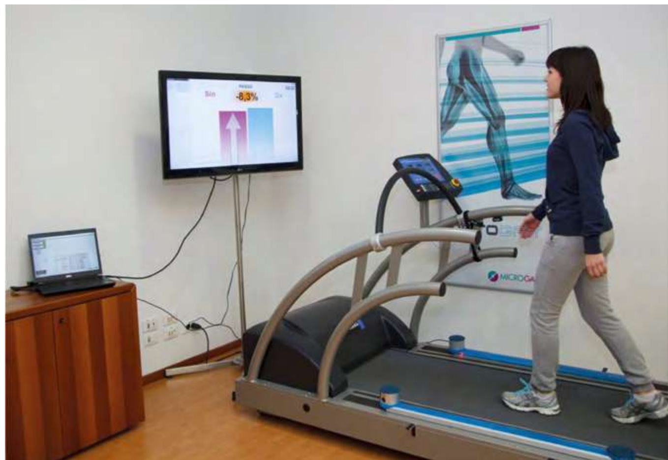
Figura 59: OptoGait installato ai lati del treadmill per la rilevazione di eventuali asimmetrie nella camminata Immagine tratta dal sito ufficiale Microgate
