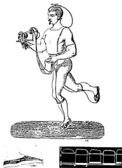
Fig. 10 - Le scarpe pneumatiche utilizzate per studiare la locomozione. Sopra il corridore che calza le scarpe pneumatiche e sostiene l'apparecchio registratore.
