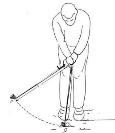
Fig. 27: la velocità lineare è uguale al prodotto della sua velocità angolare e del raggio di rotazione.
