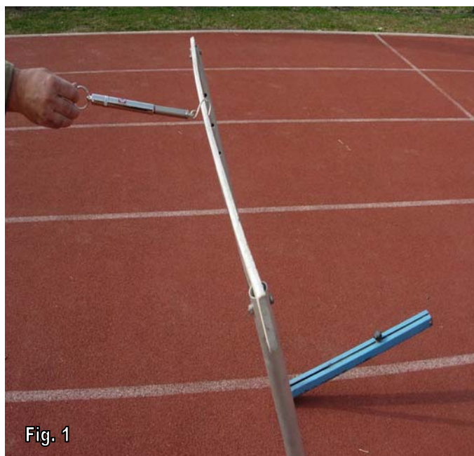
Ostacolo sottoposto a trazione lineare con Dinamometro ABC tipo H5395-0005 (Fig. 1)
