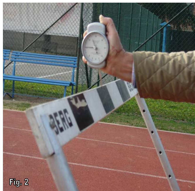
Ostacolo sottoposto a spinta lineare con Dinamometro Kontaktor JC - Juwel (Fig. 2)
